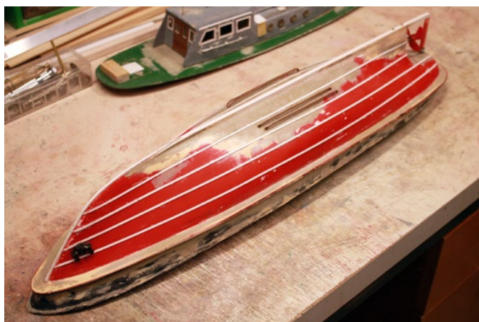
Am Rumpf wurde die Überplattung der Stahlplatten mit Polystyrolstreifen nachgestellt
