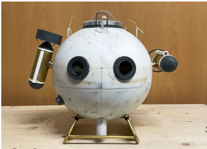
Durch die leicht schräge Anbringung der Gondeln kann das U-Boot traversieren
