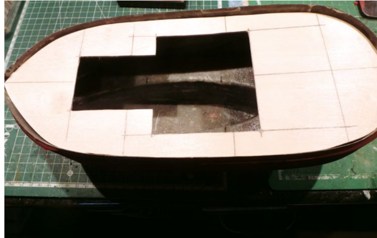
Das Deck aus 3 mm starkem Birkenperrholz wird eingepasst
