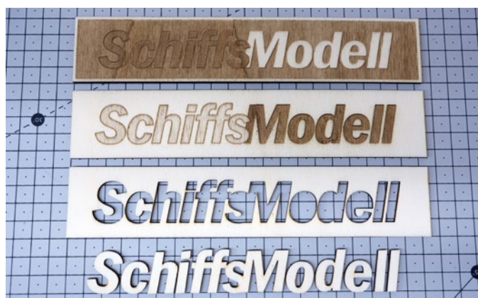
Oben ist das unbearbeitete Bild graviert worden, die weiße Schrift hebt sich besonders gut ab. Das grau-schwarze Logo ist leicht zu gravieren und die Buchstaben sind einfach zu lasern
