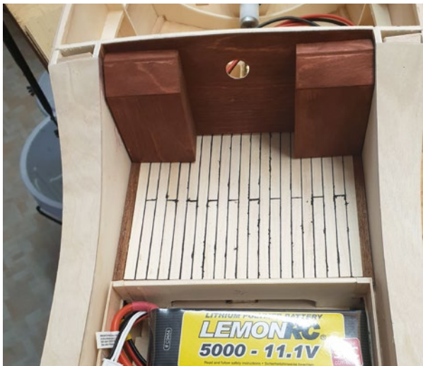
Der Boden der Plicht wird außen fertig gebaut und dann eingesetzt
