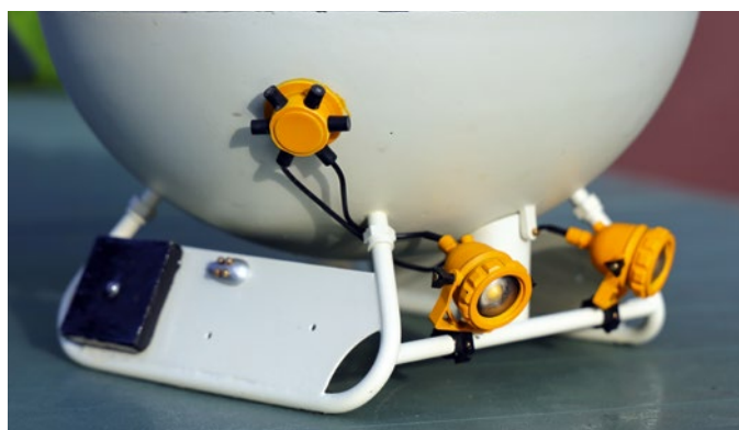
Die Scheinwerfer wurden nach einer CAD-Zeichnung gebaut. Sie werden originalgetreu aus einer Steckdose mit Strom versorgt
