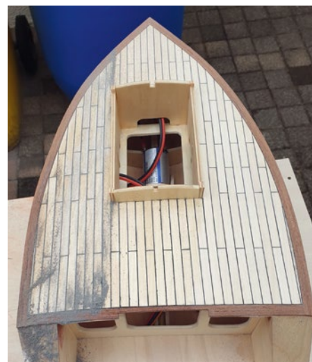
Das Backdeck wird aus Ahornleisten auf dem Unterdeck aufgeklebt. Die Kalfaterung aus Fotokarton wird danach weggeschliffen. Macht Arbeit, sieht dann aber super aus
