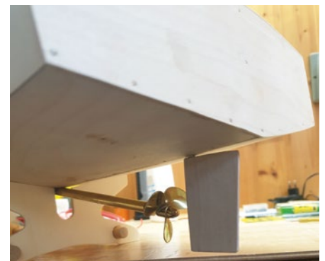
Mit etwas Vorarbeit lässt sich das Stevenrohr problemlos einbauen
