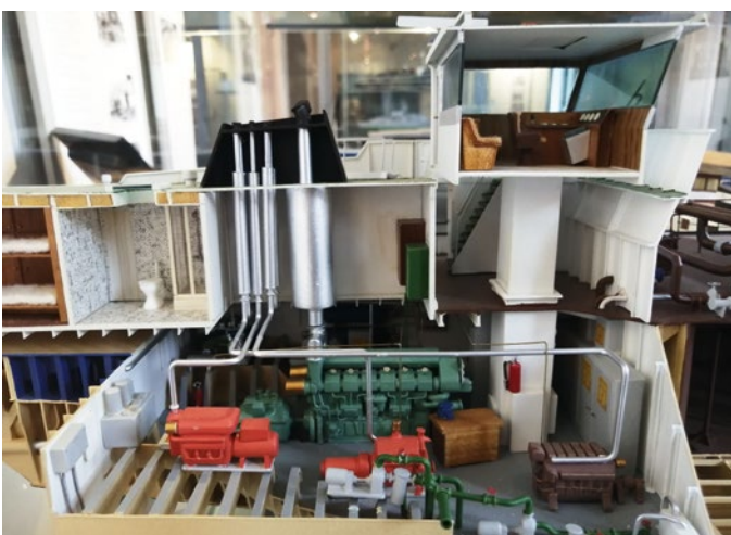
Das Schnittmodell des Hecks eines Binnenschiffs mit Maschine und Wohnung
