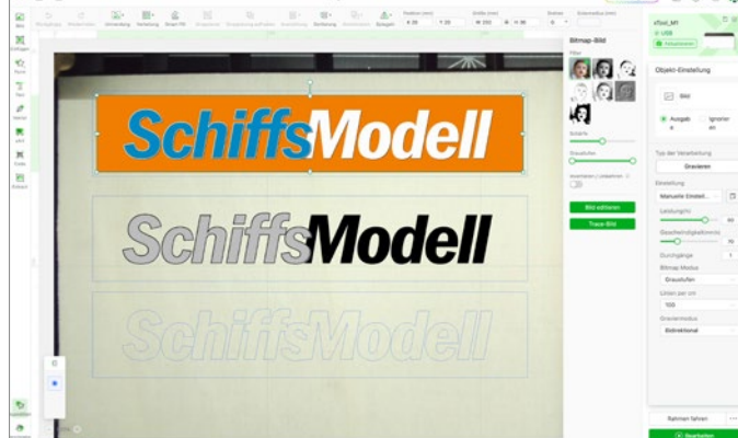
In Creative Space lassen sich Bilder, beispielsweise Logos, importieren und umwandeln, um diese zu gravieren oder deren Konturen zu lasern beziehungsweise zu plotten
