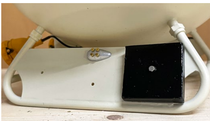
Die Ballastkörper an den Kufen sind aus Blei gegossen
