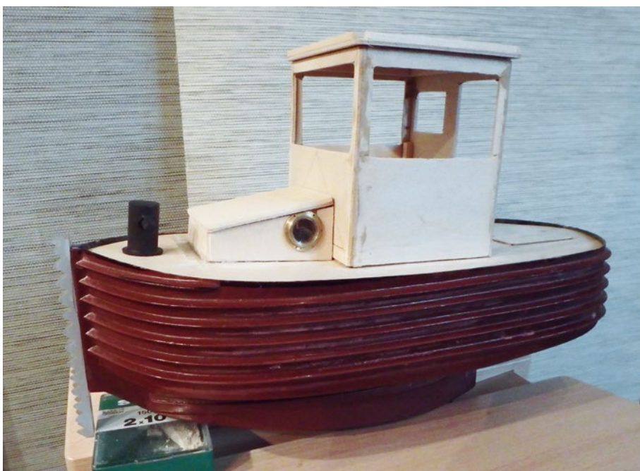
Die Säge am Vorsteven ist ein U-Profil aus Aluminium, der Aufbau besteht aus Birkenperrholz
