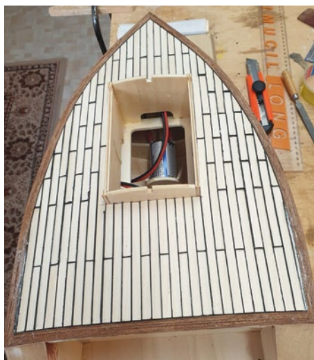
Das Backdeck wird aus Ahornleisten auf dem Unterdeck aufgeklebt. Die Kalfaterung aus Fotokarton wird danach weggeschliffen. Macht Arbeit, sieht dann aber super aus
