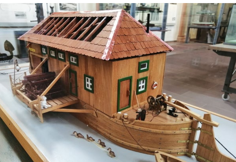
Die Schiffsmühle zog bei Bedarf von Ort zu Ort und wurde im Fluss verankert
