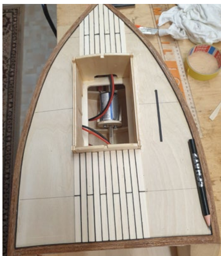
Das Backdeck wird aus Ahornleisten auf dem Unterdeck aufgeklebt. Die Kalfaterung aus Fotokarton wird danach weggeschliffen. Macht Arbeit, sieht dann aber super aus
