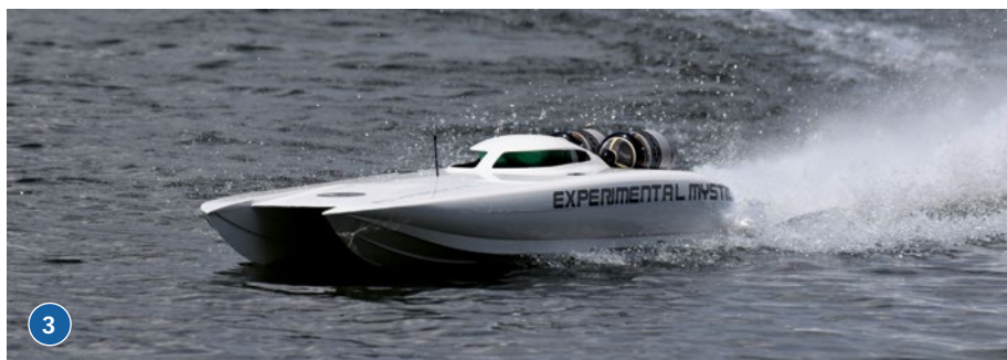
3) Die MYSTIC von Matthias Gneuß wird von zwei Schubturbinen angetrieben. 4) Die Turbinen am Heck haben einen unglaublichen Schallpegel
