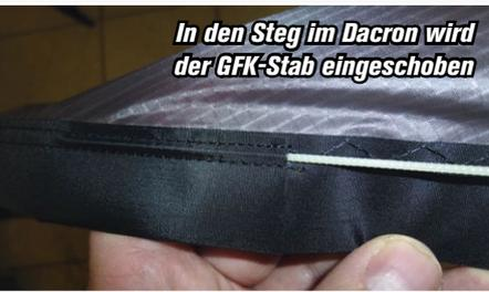
**In den Steg im Dacron wird der GFK-Stab eingeschoben**
