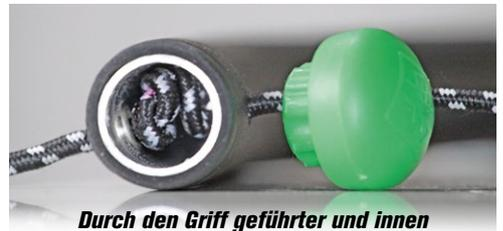
*Durch den Griff geführter und innen verknoteter Tampen, rechts das aufgesteckte und verklebte Kappenende*
