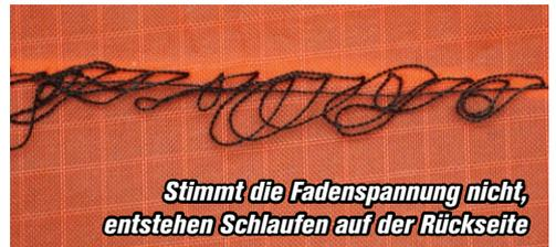
Stimmt die Fadenspannung nicht, entstehen Schlaufen auf der Rückseite
