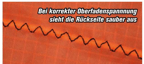
Bei korrekter Oberfadenspannung sieht die Rückseite sauber aus
