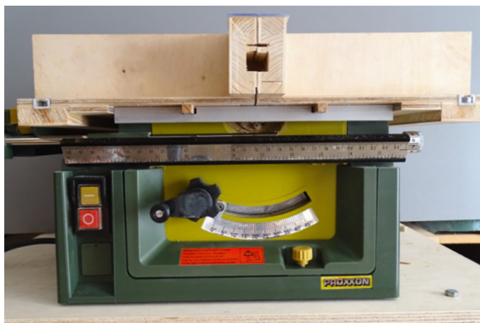
Kurbel und Sägeschlitten erleichtern die Arbeit ungemein
