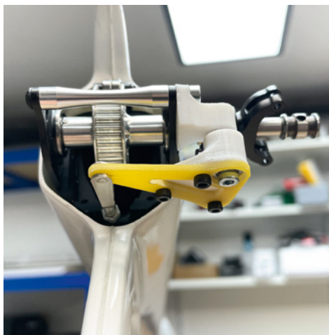
Um die Geometrie der neuen Heckenlenkung zu überprüfen, wurden entsprechende Teile im 3D-Druck erstellt
