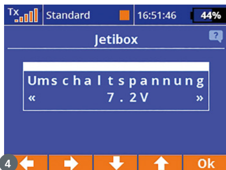
4) Die Hepf-Weiche lässt sich über die Jeti-Box-Funktion des Senders konfigurieren, wie zum Beispiel die Parametrisierung der Umschaltspannung. 5) In diesem Menü kann man vorgeben, ob der Backup-Akku während des Einsatzes durch das BEC des Motorcontrollers geladen werden soll
