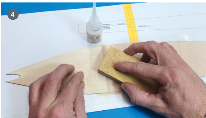
4) Bei den Rumpfbepunktungen sind ein paar 1,5-mm-Balsa-Segmente zusammenzufügen, damit die Maserung in konstruktiv nützliche Richtungen weist. Ich setze solche Teile immer auf trennender Folie mit dünnflüssigem Sekundenkleber zusammen und schleife sogleich mit 120er-Papier sanft drüber. 5) Aufgrund des Motorseitenzugs sind die Rumpfseitenteile vorne unterschiedlich. Hier gilt akute Verwechslungsgefahr, deshalb sind solche Stellen stets eindeutig zu beschriften
