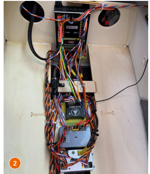
1) Spezielle Tanks mit 2.300 ml Fassungsvermögen kommen im Diamond zum Einsatz. 2) Oben im Bild zu erkennen die Central Box 320, unten beziehungsweise weiter vorne sind Cortex Kreisel, GSU und Electron Fahrwerks-Elektronik platziert
