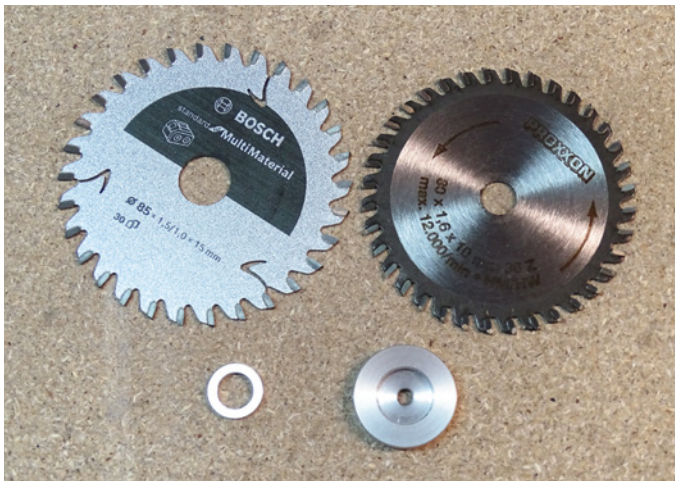
Vergößerte Anpressplatte und Reduzierhülse für vielfältige Sägeblattwahl
