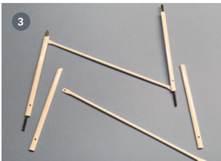
1) Die Schwimmer-Schablone aus Wellpappe hilft beim Finden des richtigen Anstellwinkels und der Stufenposition. 2) Die V-Stiele der Schwimmer sind da befestigt, wo vorher das Einziehfahrwerk saß. 3) Die Stahlrohr-Profile aus dem Schwimmerset der Turbo-Timber konnte ich nach kleinen Änderungen für die N-Stiele der Beech verwenden. 4) Die Sperrholzplättchen am Ende der V-Stiele passen in entsprechende Schlitze der Schwimmer. 5) Die N-Stiele stützen die Schwimmer diagonal gegen das Flügelmittelstück ab. 6) Die V-Stiele habe ich noch vorbildähnlich mit Superboard verkleidet. 7) L-förmige Kunststoffprofile schützen die Schwimmerunterseite im vorderen Bereich gegen Beschädigungen
