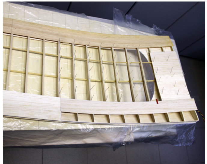
Gebaut wird auf der ebenen Helling, dennoch war der Flügelschwung zuvor zu berücksichtigen
