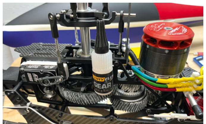
Links: Auch am Akku kann man Gewicht sparen. Für die F3C-Fliegerei sind die leichten 30C-Akkus von ManiaX mehr als ausreichend. Rechts: Wer gut schmiert, der gut fliegt. Bei der Getriebeschmierung hat sich DryFluid Gear Lube bewährt. Dieser Hightech-Schmierstoff trocknet auf den Zahnrädern ab und „fängt“ so keinen abrasiven Staub
