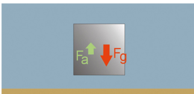
Abbildung 3: Kräfte auf einen Körper in einem fluiden Medium
