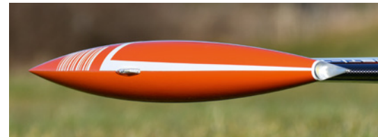
Charakteristisch sind die Tiptanks und hier wirken besonders die 3D-Druck-Spitzen
