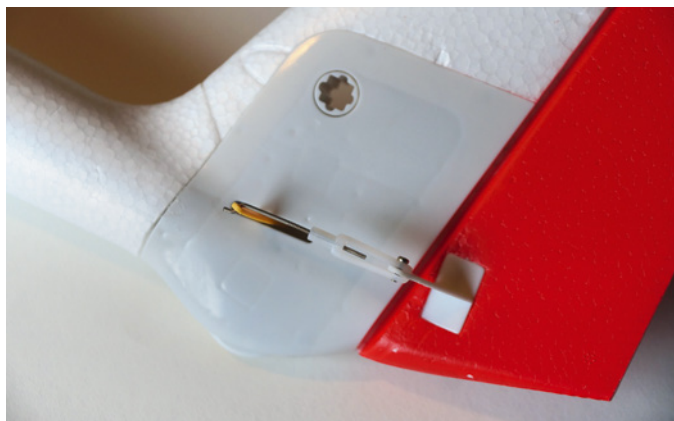
Die Seitenrudieranlenkung ist ebenfalls erfreulich kurz und direkt. Massiv ausgeführt ist die Abdeckung
