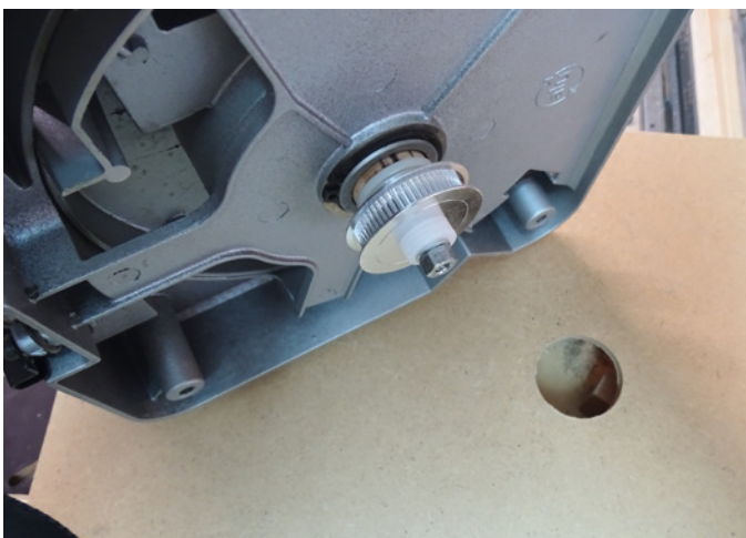
Das Lager der Winkelverstellung ist um ein Modulrad zu erweitern
