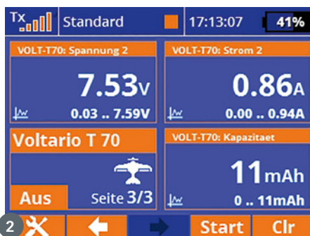
1) So übersichtlich werden die aktuellen Daten Spannungslage, Strom und entnommene Kapazität des Hauptakkus angezeigt. 2) Anzeige des Backup-Akkus im Display der Jeti-Anlage. 3) Der Verlauf der Stromaufnahme kann grafisch visualisiert werden
