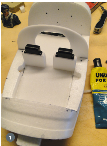
1) Auf einer Depron-Grundplatte montierte ich eine Cockpit-Rückwand und neue Sitzlehnen.
