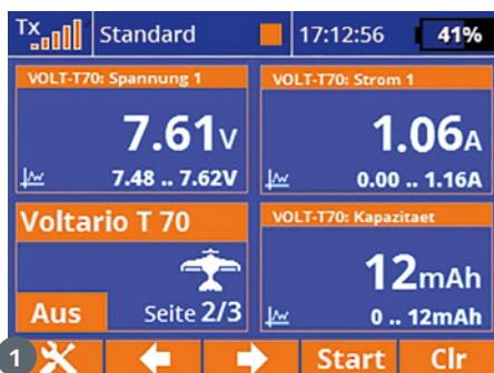
1) So übersichtlich werden die aktuellen Daten Spannungslage, Strom und entnommene Kapazität des Hauptakkus angezeigt. 2) Anzeige des Backup-Akkus im Display der Jeti-Anlage. 3) Der Verlauf der Stromaufnahme kann grafisch visualisiert werden
