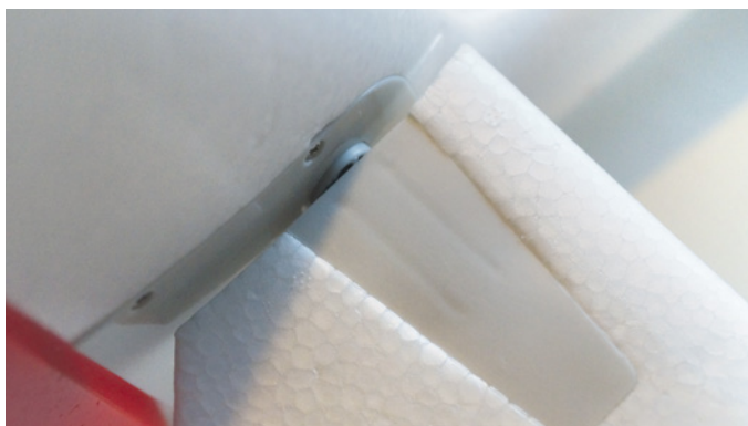
Die Pendelruder sitzen drehbar gelagert im Leitwerk
