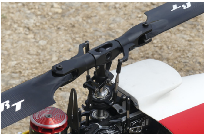
Der Rotorkopf entspricht nahezu dem Serienmodell. Lediglich die Anlenkarme wurden zugunsten einer höheren Auflösung um 4 mm verlängert
