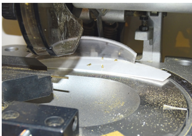
Die Fangeinrichtung ist schnell erstellt und hilft die Kleinteile aufzufangen
