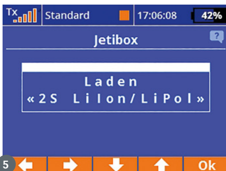
4) Die Hepf-Weiche lässt sich über die Jeti-Box-Funktion des Senders konfigurieren, wie zum Beispiel die Parametrisierung der Umschaltspannung. 5) In diesem Menü kann man vorgeben, ob der Backup-Akku während des Einsatzes durch das BEC des Motorcontrollers geladen werden soll
