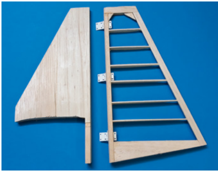
Die Flosse ist bereits beplankt – das Ruder folgt, zeigt hier aber noch die Bauweise
