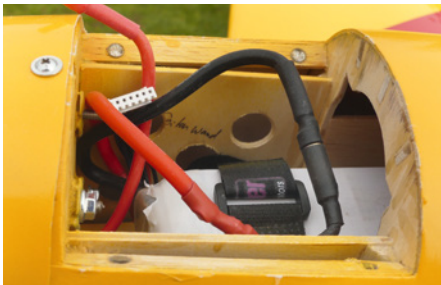
Obwohl der Akku weit vorne liegt, war noch zusätzliches Trimmgewicht unter der Motorhaube nötig
