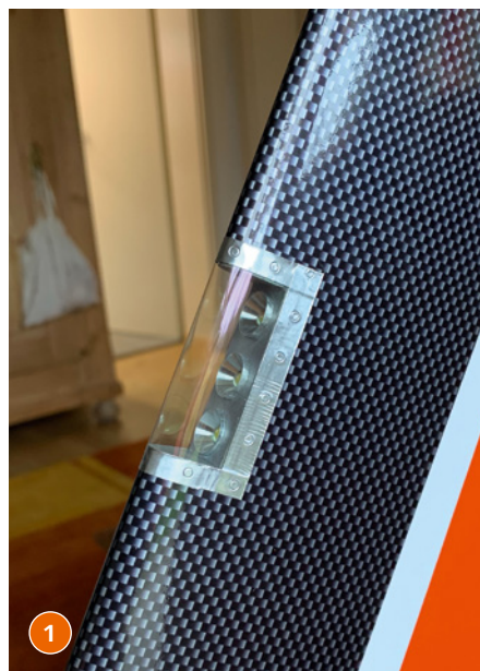
1) Die Scheinwerfer in den Flügeln sitzen in zurechtgeschnittenen Bereichen, die selbst angepasst werden müssen. Verschlossen ist das Ganze mit dünner Folie. 2) Das Display der GSU zeigt Daten der Turbine und ist vor allem beim Starten hilfreich
