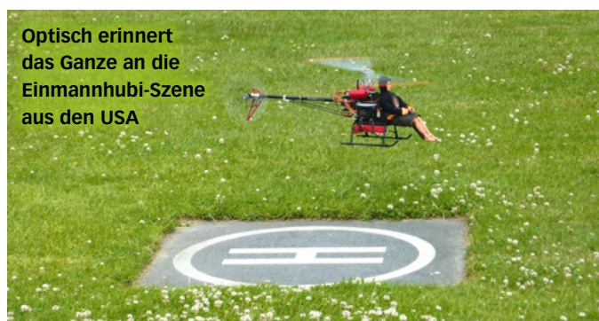
Landegestell mit Akkuplatte und das Puppen-Innenskelett entstanden im Eigenbau aus Alu
