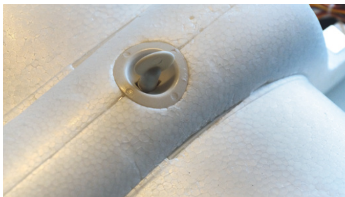
Die Tragflächenverriegelung erfolgt werkzeuglos, aber leider nicht unsichtbar, auf dem Rumpfrücken
