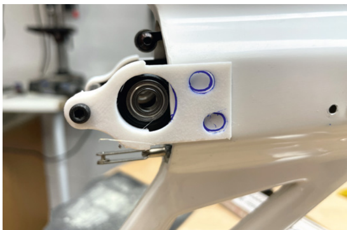
Um die Bohrungen zum Verschrauben des Heckgetriebes im Rumpf einfacher zu positionieren, fertigte der Autor eine 3D-gedruckte Schablone an
