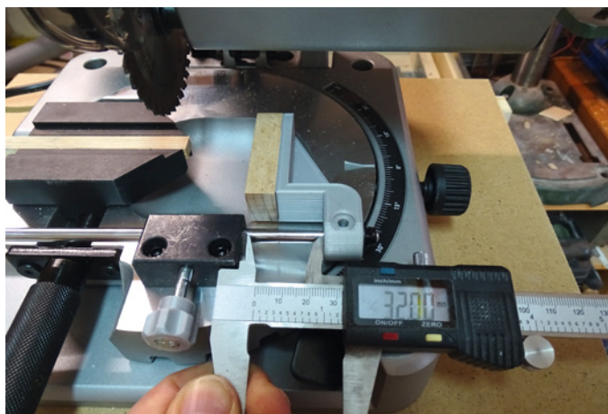
Der neue Längenanschlag bietet bessere Möglichkeiten beim Einstellen des Längenmaßes
