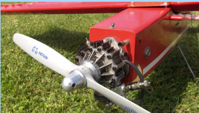
Der O.S.-Wankelmotor, hier auf einem Middle Stick montiert, war schon Anfang der 1970er-Jahre ein Exot, heute ist er nur noch selten zu sehen
