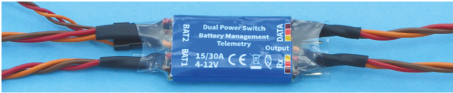
Die Anschlüsse, bis auf den ansteckbaren Schalter, sind fest angelötet
