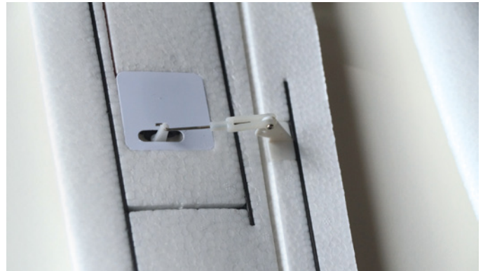
Die sehr direkte Querruderanlenkung ist spielfrei. Die Tragflächenunterseite ist durch die Kabelkanäle und CFK-Verstärkungen reichlich zerklüftet
