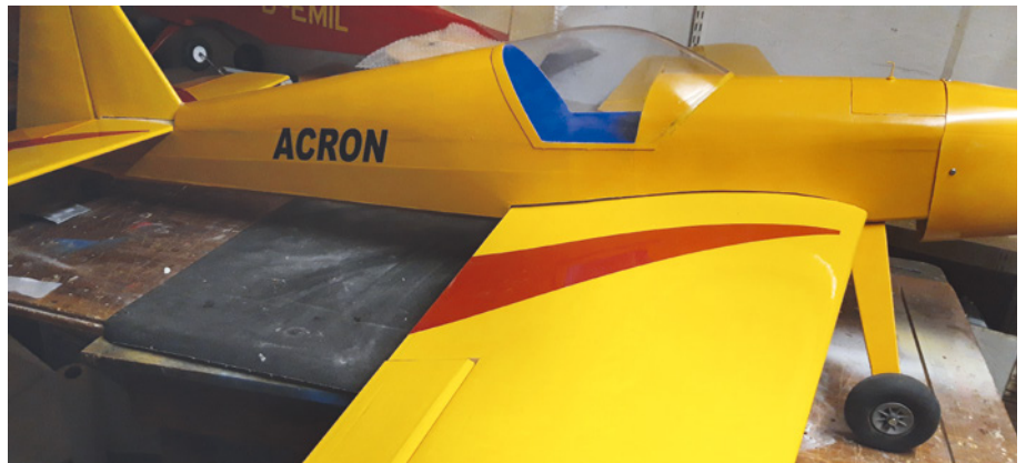
Die Styro-Balsa-Fläche fügt sich gut an. Der Akkudeckel erhielt einen Griff
