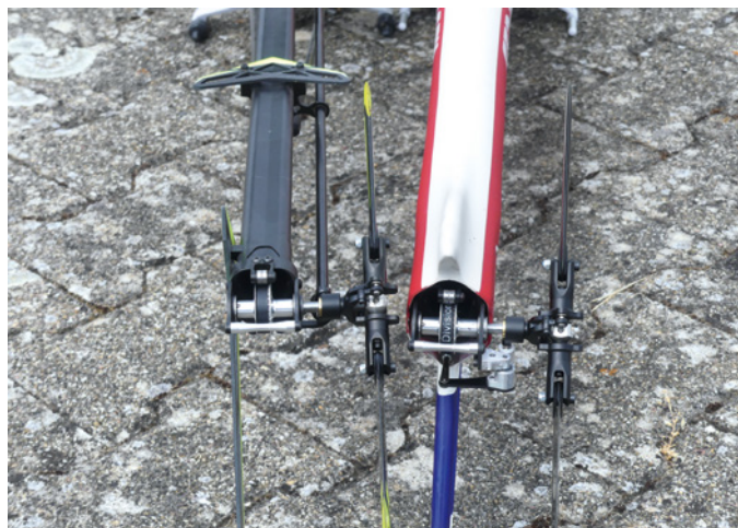
Hier erkennt man gut, warum die eigentlich geniale, spielfreie Heckenlenkung des Strike sich nicht für den Einbau in einen Rumpf eignet
