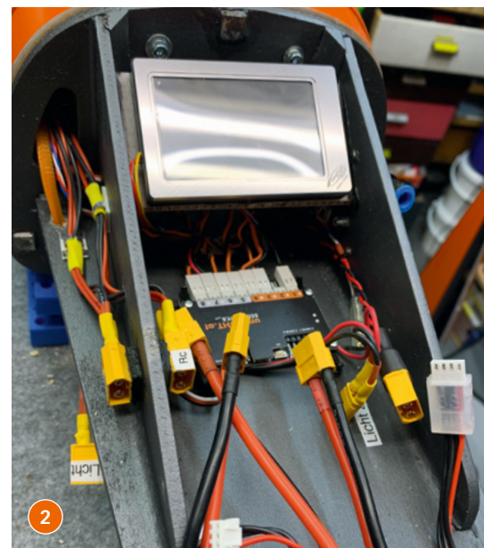
1) Die Scheinwerfer in den Flügeln sitzen in zurechtgeschnittenen Bereichen, die selbst angepasst werden müssen. Verschlossen ist das Ganze mit dünner Folie. 2) Das Display der GSU zeigt Daten der Turbine und ist vor allem beim Starten hilfreich
