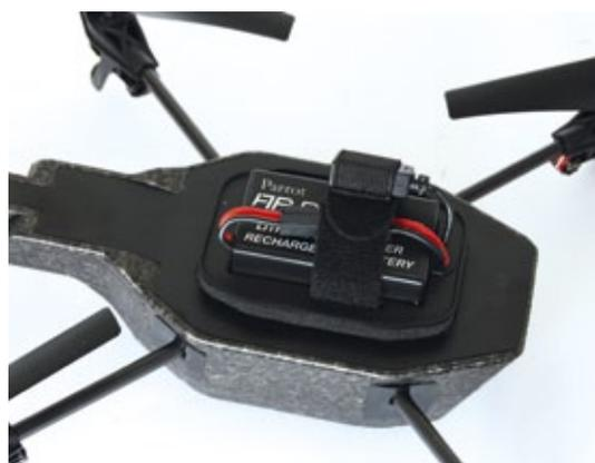
**Der Akku sitzt sicher gebettet mittig im Modell. An der Befestigungsschleife wartet ein USB-Stecker zur Aufnahme eines Sticks. Darauf können Flugvideos und Bilder gespeichert werden**
