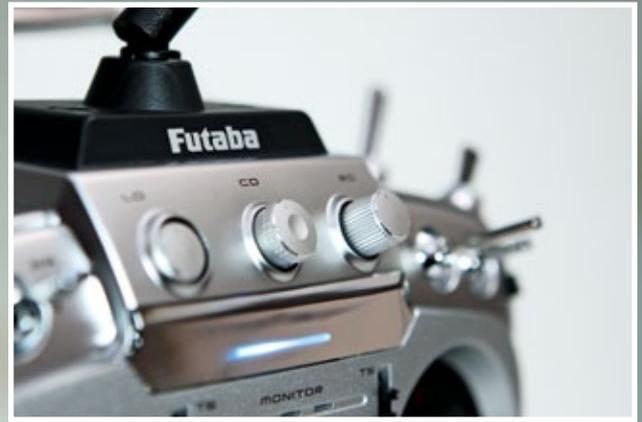
**Die äußeren der beiden Drehgeber besitzen einen Endanschlag und sind zudem gegen unbeabsichtigtes Verstellen versenkbar ausgeführt**
