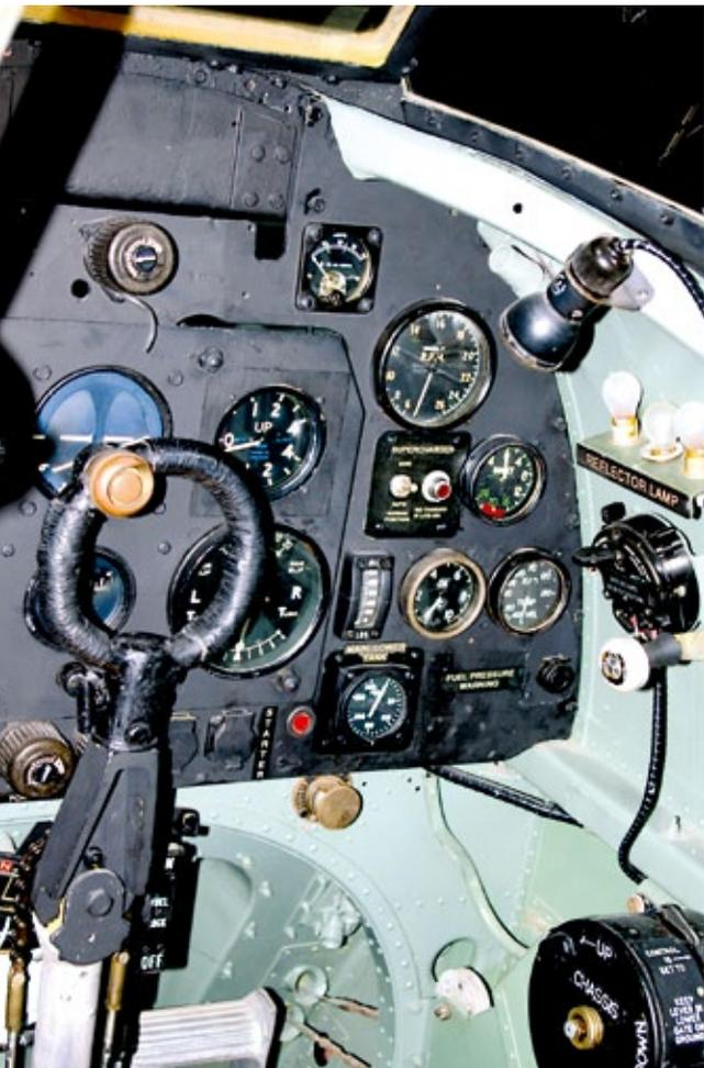
**Der ringförmige Griff am Steuerknüppel erlaubte es dem Piloten, bei Bedarf auch mit beiden Händen zuzupacken**
