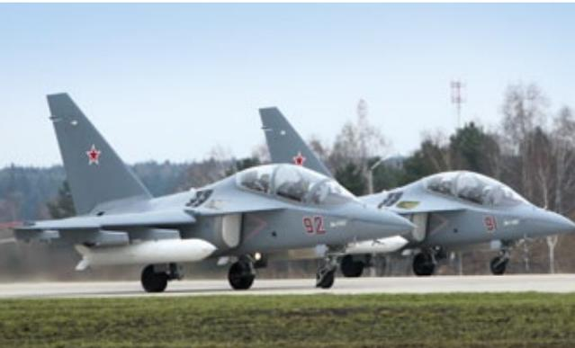
Die Yak 130 von Jakowlew ist ein zweistrahliger Trainingsjet. Eine Besonderheit sind die bis zum Bug vorgezogenen Flügelwurzeln und die zusätzlichen, darin untergebrachten Triebwerkseinlässe
