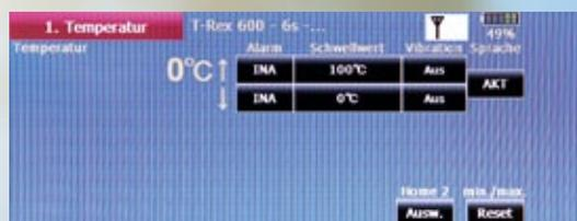
**Für fast jeden Telemetrie-Kanal kann eine untere und eine obere Alarmschwelle definiert werden**
