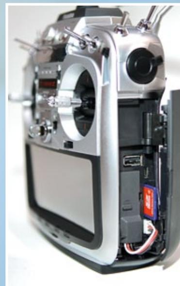
**Unter dem rechten Griffteil befinden sich Akku, USB-Anschluss und ein SD-Kartenslot für unbegrenzte Modellspeicher. Der Mini-USB-Port dient nur für Servicezwecke**
