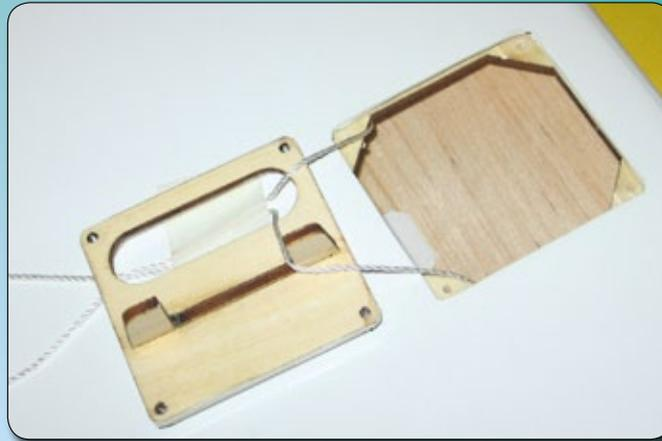
*In der Fläche verlegte Schnüre erleichtern das Einziehen der Servokabel*
