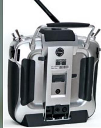
**Unterhalb der Trainerbuchse befindet sich das Kamera-Auge. Die 30.000 Pixel liefern exakt das für die Modellspeicher benötigte Bildmaß**
