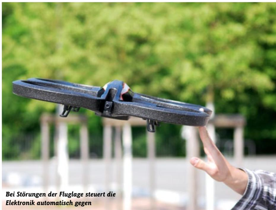
**Bei Störungen der Fluglage steuert die Elektronik automatisch gegen**
