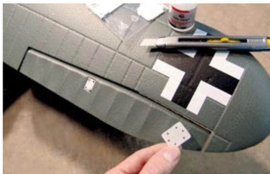
**Aufgrund der Bauform des Querruders ist der äußere Bereich nicht anscharniert. Um ein Abscheren des Ruders zu vermeiden, reicht das Einkleben eines Vliesscharniers**
