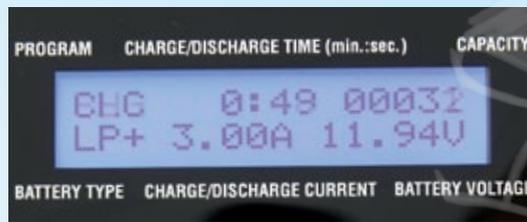
**Ein 3s-LiPo mit 3.000 Milliamperestunden Kapazität wird mit 1C, also exakt 3 Ampere geladen. Angezeigt ist die aktuelle Gesamtspannung des Akkupacks**
