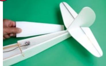
Sobald Höhen- und Seitenleitwerk mit angeschlossenen Rudern befestigt sind, montiert man den individuell einzupassenden Deckel
