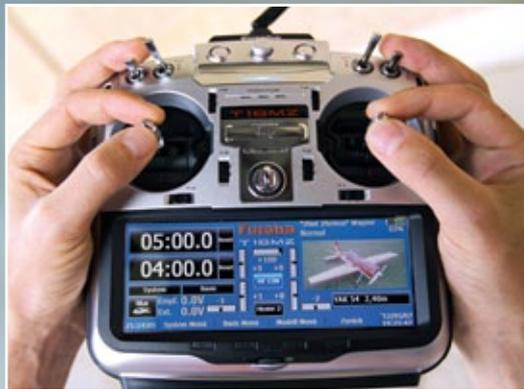
Während der gewünschte Steuermode schon bei der Bestellung der T18 angegeben werden muss, lassen sich Federhärte der Knüppel sowie Bremse/Ratsche stufenlos einstellen. Sogar die Knüppelneigung kann um ein paar Grad nach innen oder außen variiert werden
