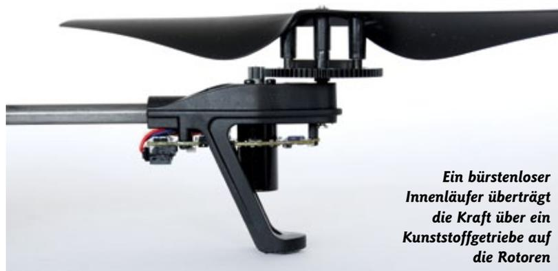
*Ein bürstenloser Innenläufer überträgt die Kraft über ein Kunststoffgetriebe auf die Rotoren*
