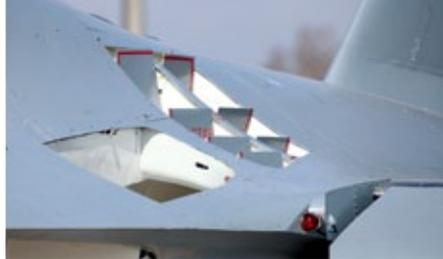
*Die Yak 130 verfügt über ein aufwändiges System der Ansaugluftumsteuerung, das ebenso im Modell verwirklicht wurde*
