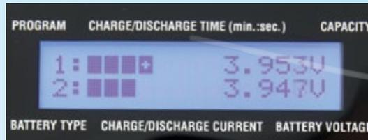
**Bei aktivem Balancer kann der Wert jeder einzelnen Zelle dargestellt werden. Die Balancer-elektronik gleicht den Akkupack im Spannungsniveau an**
