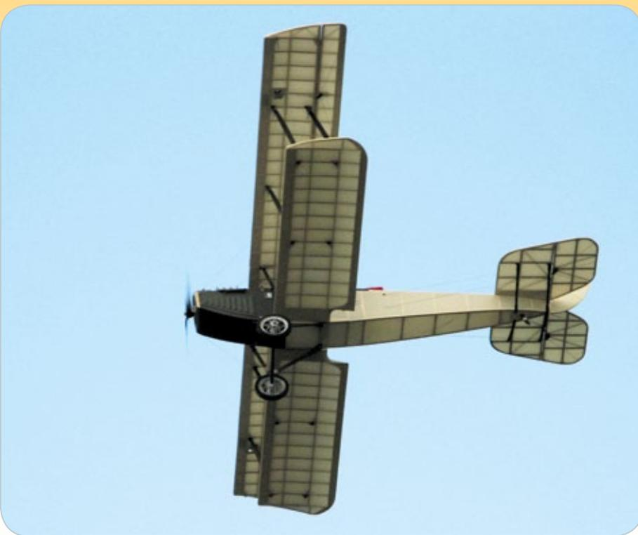
**Abbildung 3: Das Höhenleitwerk der Curtiss Jenny mit 1.800 Millimeter Spannweite ist gegenüber dem Original um 50 Prozent größer – man sieht es kaum**
