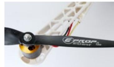
**Die Graupner E-Props tragen zu einem vibrationsfreien Lauf bei, da sie sich gut wuchten lassen und auch unter Last noch formstabil bleiben**
