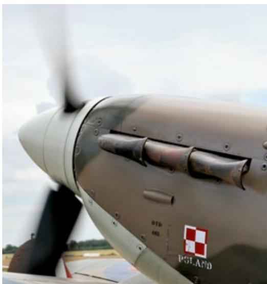
**Aerodynamisch günstig geformte Auspuffanlage**
