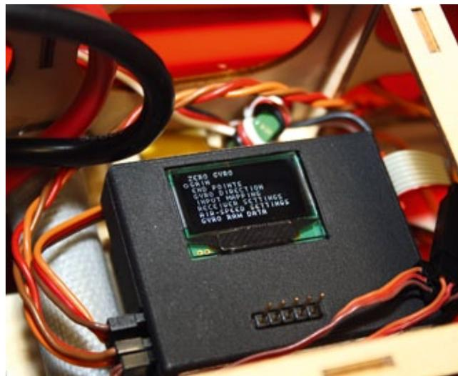
**Labormuster des neuen 3D-Kreiselsystems für Flächenmodelle mit integriertem OLED-Display. Anstatt eines Staudruckrohrs kommt hier ein hochmoderner GPS-Empfänger als Geschwindigkeitssensor zum Einsatz**
