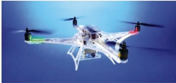
des Schwebeflugs, einen Sportmodus der Überflüge, Loopings und Rollen ermöglicht sowie den sogenannten Agility-Modus, bei dem die Wendigkeit des Modells noch einmal erhöht wird. Ein Futaba-Summensignalempfänger wird allerdings benötigt.
