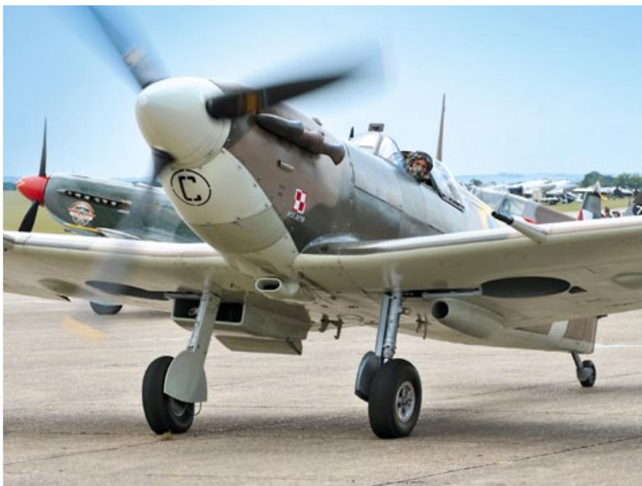
**Beim Rollen musste der Pilot seitlich aus der Maschine blicken, um an der langen Motorhaube vorbei zu sehen**
