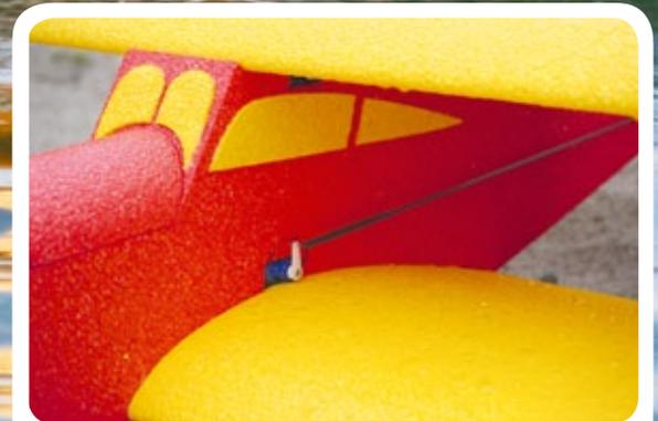
*Direkt in den Rumpf sind beide Ruderservos eingebaut. Die CFK-Stangen entfalten auch optische Wirkung*
