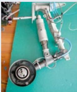
**Der Aufbau des Hauptfahrwerks mit Schwinge und Federdämpfer entspricht in der Kinematik exakt dem Original, um sich in dem engen Fahrwerkstunnel einfallen zu können**
