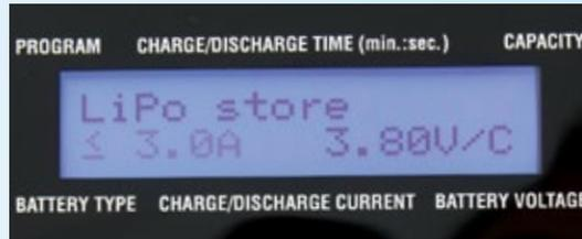
**Sollen LiPos länger gelagert werden, bereitet man diese mit Hilfe des Storage-Modus' darauf vor. Der Akku wird dabei auf etwa 50 Prozent seiner Kapazität geladen**
