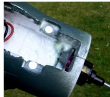
**Der Akkuraum war zu vergrößern und der Motorspant nachzukleben**
