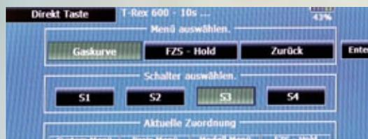
**Die Schnellwahltasten unterhalb des Displays lassen sich modellspezifisch mit beliebigen Funktionen belegen. Dazu als erstes die gewünschte Funktion aufrufen (beispielsweise Gaskurve) und im zweiten Schritt S1 und S4 gleichzeitig drücken. Es erscheint ein Auswahlmenü zum einfachen Verknüpfen der Funktion**
