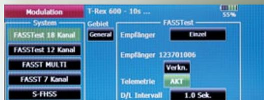
**Eine der großen Neuerungen ist die Einführung der FASSTest-Modulation, die Telemetrie ermöglicht**
