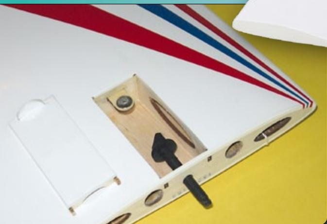
Zur Tragflächenfixierung dient eine Nylonschraube, an die man leicht herankommt
