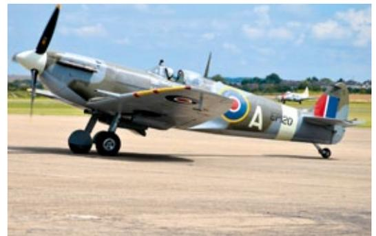
**Bei einigen Maschinen der Version Mk.Va wurden die Flügelspitzen gekappt, um die Manövrierfähigkeit in Bodennähe und die Rollrate zu erhöhen**
