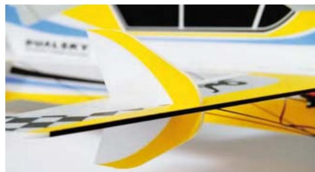
**Die so genannten Messerflug-Unterstützer stabilisieren das Modell entscheidend**
