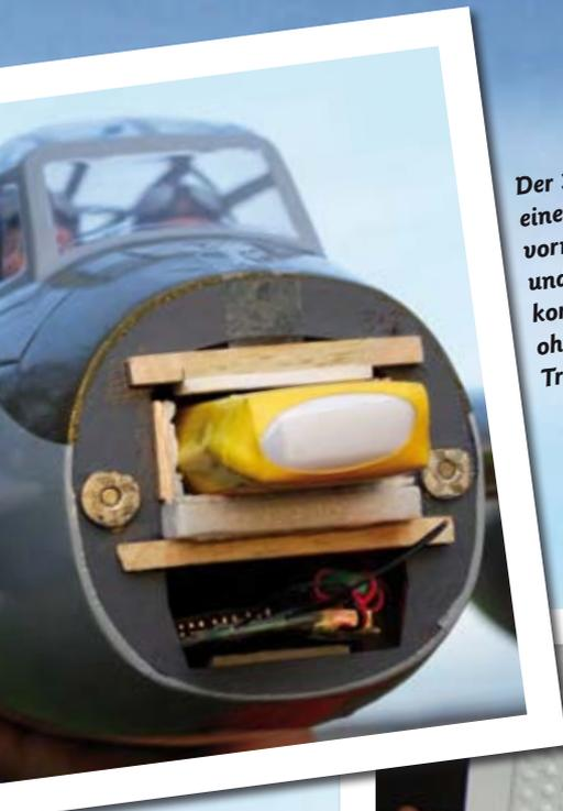
*Der 3s-LiPo wurde mit Hilfe eines neuen Akkubretts ganz vorne im Rumpf positioniert und ermöglicht damit die korrekte Schwerpunktlage ohne Verwendung von Trimmgewichten*
