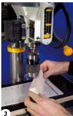
**4. Genau an den Markierungen ausgerichtet, befindet sich der Stempel nun mittig unter dem Bohrfutter, das weit geöffnet wird, um eine schön große, plane Pressfläche des Futters auf dem Stempel zu erhalten**
