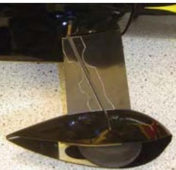
**Für eine individuelle Lösung zur Befestigung der Fahrwerksverkleidung muss hier die Folie weichen**
