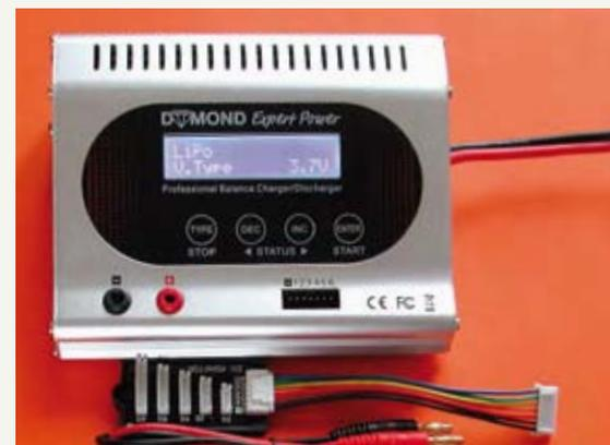
**10 Ampere Ladestrom bis 20 Volt Ladespannung sind voll abrufbar**
