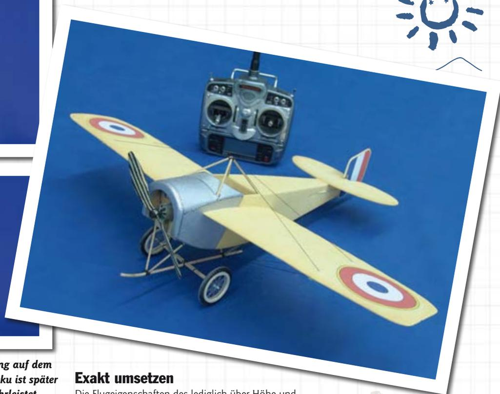
**Alle RC- und Antriebskomponenten sind eng auf dem Motorspant untergebracht. Zugang zum Akku ist später von unten durch eine Rumpfföffnung gewährleistet**
