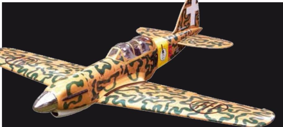
**Pichler Modellbau** Die ARF Fiat G-59 von Pichler Modellbau überzeugt durch ihre gute Verarbeitung, eine hohe Detailtreue und ein ausgezeichnetes Preis-Leistungs-Verhältnis. Das Modell wurde speziell für Elektroantriebe konstruiert, kann aber auf Wunsch auch mit einem Verbrennungsmotor ausgerüstet werden. Technische Daten: Spannweite: 1.580 Millimeter, Länge: 1.120 Millimeter, Gewicht: 2.600 Gramm. Der Preis: 159,- Euro.
