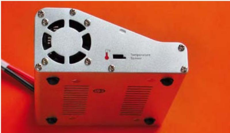
Der eingebaute Ventilator agiert vornehm leise. Daneben der Anschluss des Temperatursensors
