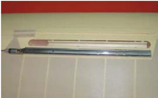
Damit der Störklappen-Antrieb im eingebauten Zustand Platz hat, muss eine Rippe in Richtung Tragflächenwurzel ebenfalls ausgenommen werden
