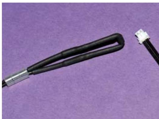
Detailansicht eines Temperatursensors. Die Länge des Messkopfes mit den Messwiderständen beträgt zirka 22 Millimeter
