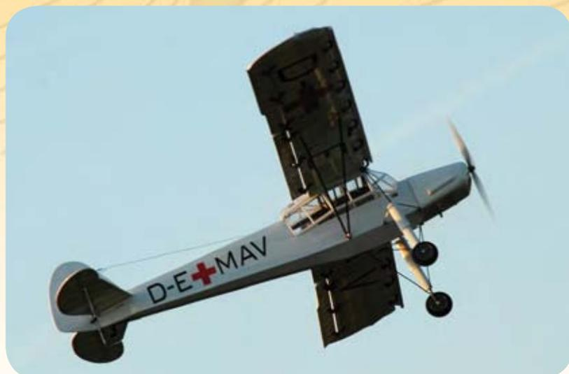
Eine wirklich deutliche Erhöhung des kritischen Anstellwinkels ist hingegen durch den Einsatz von Vorflügeln und Spaltklappen – idealer Weise in Kombination – möglich; vergleiche dazu Artikel „Vorflügel“ aus **Modell AVIATOR** 8/2010. Durch diese Maßnahme sind Anstellwinkel von bis zu 20 Grad erreichbar. Dies ist mehr als eine Verdopplung der Werte im Vergleich zu konventionellen Profilen – siehe Abbildung 5.
