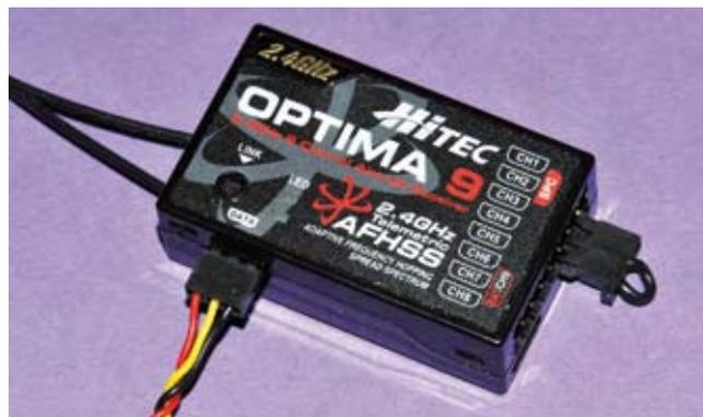
So wird das Data-Kabel von der Sensor-Station in den Optima 9 angesteckt
