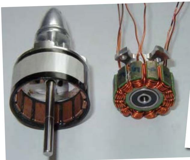
**Das erste fertige Mosquito-Triebwerk mit dem im Text erwähnten neuen, vorderen Kugellager**
