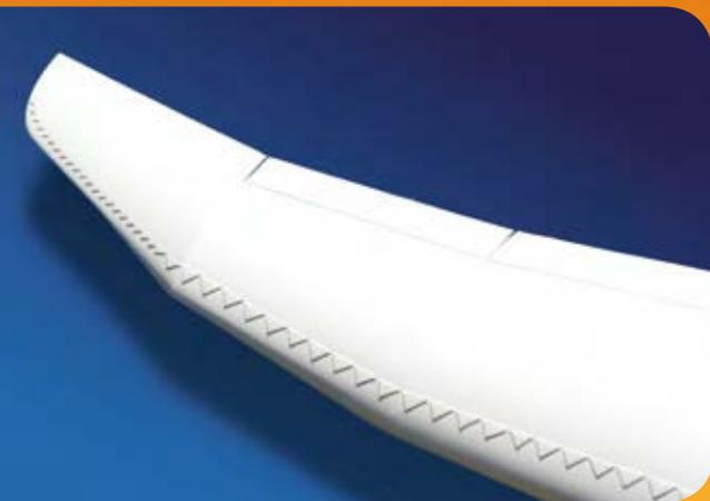
**Abbildung 4: Turbulatoren zur Vermeidung einer Laminarablösung**
