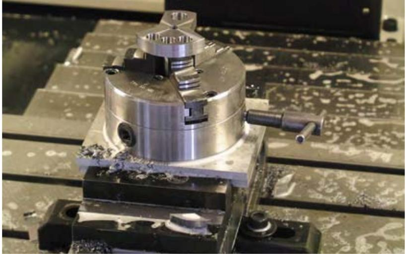
*Ein Bestandteil der Kurbelwelle ist fertig aus dem Vollen gefräst*
