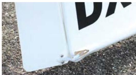
**Die Anlenkung zum Seitenrunder ist über einen Seilzug realisiert**
