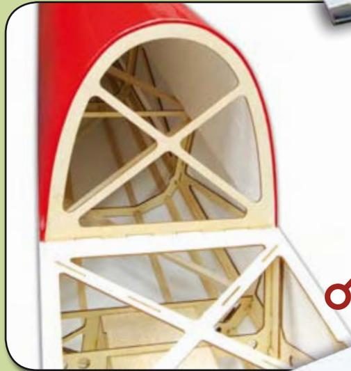
*Der Rumpfrücken ist mit dünnem Styropor gestützt – leicht und wirkungsvoll*
