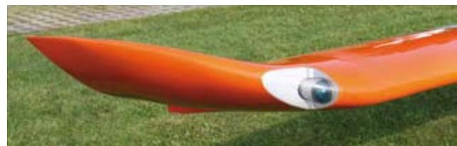
In die Winglets ist das Positionslicht integriert
