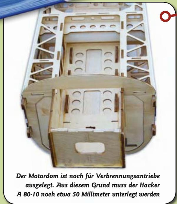
*Der Motordom ist noch für Verbrennungsantriebe ausgelegt. Aus diesem Grund muss der Hacker A 80-10 noch etwa 50 Millimeter unterlegt werden*
