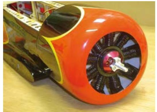
**Nach einigen Versuchen sitzt der Motor zentrisch in der mit einer Sternmotorenattrappe aufgewerteten Cowling**
