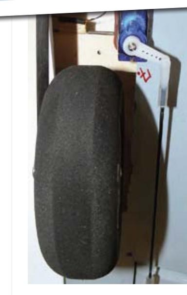
*Blick von unten auf das rechte Einziehfahrwerk in der vorgefertigten Motorgondel. Hinter dem Fahrwerksbein ist das Landeklappenservo erkennbar*
