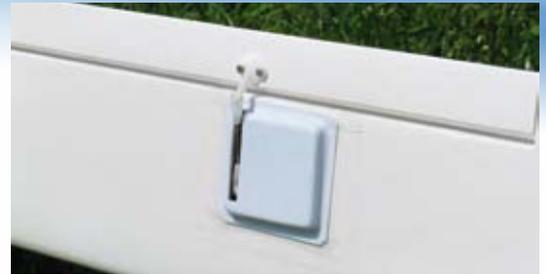
**Die Schachtabdeckung wurde großzügig aufgefellt, damit nichts streift und der Gabelkopf weit innen am Servohebel eingehängt werden kann**
