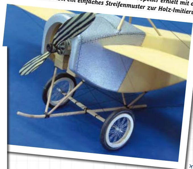
**Zum Schluss der Spinnweben-Aktion erfolgt die Abspannung der Radachsen zum Rumpf. Hierbei muss darauf geachtet werden, dass die Achse in horizontaler Richtung gerade steht, sodass beide Flügelenden denselben Abstand zum Boden haben**
