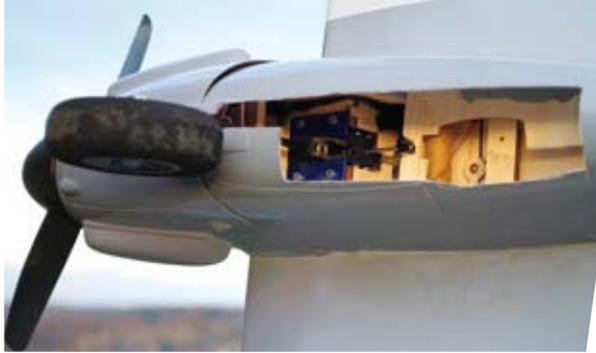
**Die zweiteiligen Motorgondeln bestehen aus lackierten GFK-Schalen und bieten im Inneren reichlich Platz**
