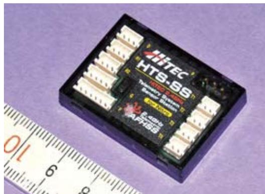
*An die kleine Sensor-Station lassen sich alle jeweils benötigten Sensoren anschließen*
