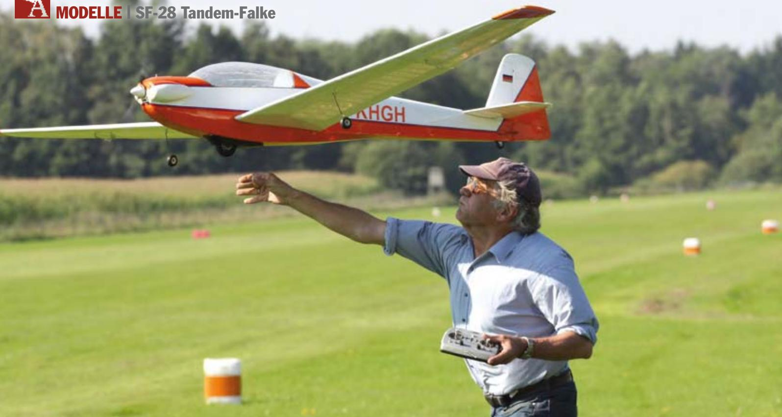
Denn der vorne werkelnde Dymond-Brushlessmotor von Staufenbiel, der das Modell-Tandem über eine aero-naut-Klappluftschraube in die Luft bringt, kommt kaum auf Temperaturen. Er benötigt nur wenig Leistung für das leichte Modell. Ein 3s-LiPo mit 2.500 Milliamperestunden Kapazität verleiht dem Motorsegler vorbildgetreue Fluggeschwindigkeiten. Einen ebenfalls einsatzfähigen 4s-LiPo setzt Rolf Wassermann seltener ein, damit ist die Kleine einfach überpowert.
