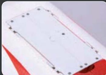
Als Besonderheit, verfügt das Modell über einen Abwurfschacht, der über die RC-Anlage geöffnet und geschlossen werden kann. So lassen sich im Flug Bonbons, kleine Fallschirmspringer und vieles mehr abwerfen!
