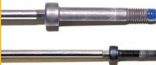
So sieht der Gewindegang aus, wenn die Schraube nach dem Aushärten des Sicherungslacks wieder mit entsprechendem Kraftaufwand herausgedreht wird
