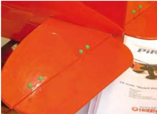
**Stecknadeln garantieren den perfekten Sitz der Vliesscharniere vor der Verklebung. Gut zu erkennen: Der Spalt an der Rumpfsseitenwand**
