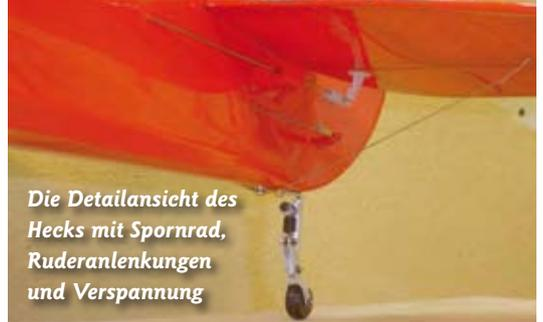
**Die Detailsicht des Hecks mit Spornrad, Ruderanlenkungen und Verspannung**
